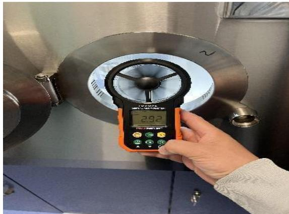
图 3-20 SPECT/CT 手套箱风速
