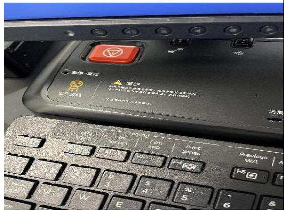
图 3-32 SPECT/CT 控制台急停按钮
